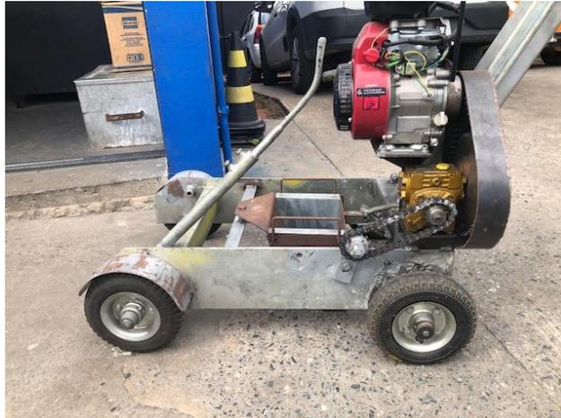
O posicionamento da sinalização no piso deve ter uma pré-marcação de forma que o deslocamento seja controlado na velocidade de aplicação. O direcionamento do equipamento pode ser manual ou remoto, desde que se oriente pela pré-marcação no piso, feita previamente com o uso de trenas, linhas gizadas e gabaritos.
