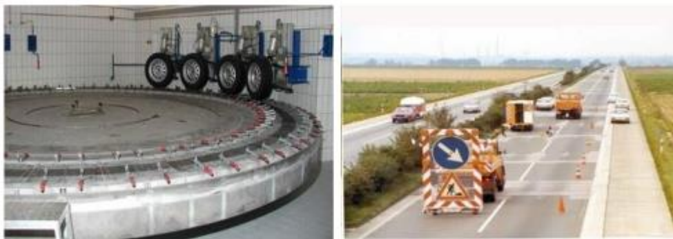
Simulador de desgaste tipo carrossel e campo de ensaio de desgaste
