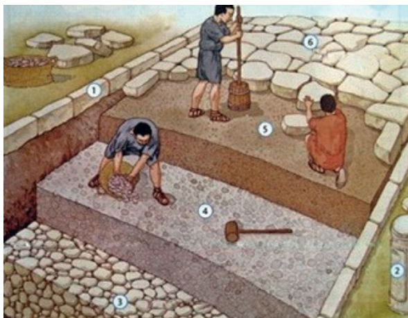
Esquema 2 - Diziam que todas as estradas levavam a Roma e o seu exército, que em tempo de paz era construtor, junto com os escravos, construíram cerca de 100.000 km de estradas. O revestimento superior era feito com as pedras planas e no eixo colocavam pedras diferentes para separar o tráfego de veículos de tração que se cruzassem.
